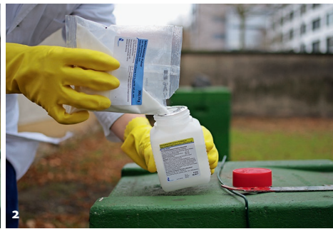
2 Einfüllen der Saccharose in die temperierte Oxalsäuredihydrat-Lösung
