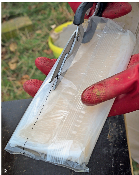
2 Aufschneiden der Kunststoffbeutel entlang der Markierung
